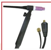
Torche tig valve : SR17V. Idéale pour un soudage tout en souplesse. Poignée moulée pour une adhérence optimale pour une soudure parfaite. Inclus dans un coffret : 2 buses (N5 : 8 mm + N7 : 11 mm), 2 supports collet (Ø1,6 + Ø2/2,4), 2 pinces étau (Ø1,6 + Ø2,4), 2 coiffes (courte + longue), 2 électrodes tungstène WR2 AC/DC (Ø1,6 + Ø2,4). Refroidissement à air. Compatible Gysmi 130P, 160P, 200P, E160 et E200 FV ainsi que ProGyS 180A et 200A PFC.
